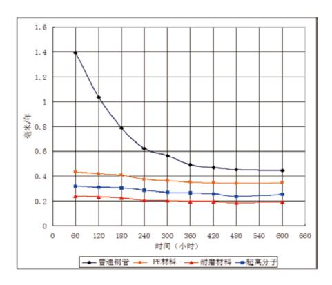
结论:铁精矿浆质量浓度65%,平均密度: 4772kg/m3;内径50mm,流速1.8-2.0米/秒,单次物料磨蚀时间为60h,共运行600h。0.1922毫米/年
